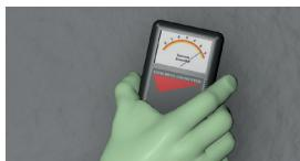
Die Bestimmung der Restfeuchtigkeit mit elektronischen Messmethoden wird nicht von allen Stellen anerkannt. Trotzdem empfehlen wir, diese zerstörungsfreie Messmethode als orientierende Messung anzuwenden.
