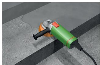
Eine auf die Schleifmaschine montierte ZEC Scheibe kann zum Anschleifen von Blechen, Fensterrahmen, Holz und Beton verwendet werden. Darüber hinaus stellt handelsübliches Schleifpapier oder die Bandschleifmaschine eine ergänzende Möglichkeit dar. Der Beton wird mindestens mit einer Diamantscheibe geschliffen.
