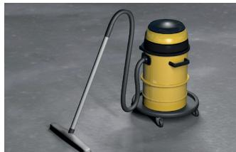
Die Endreinigung muss mittels Staubsauger vorgenommen werden. Schleifstaub in den Poren verhindert die Haftung und ist zwingend zu vermeiden.
