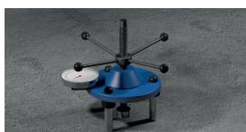
Der Untergrund wird mit geeignetem Messgerät auf die Haftzugfestigkeit geprüft. Folgende Mindestwerte sind einzuhalten:
