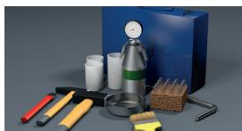
Die Bestimmung der Restfeuchtigkeit mittels CM-Messung ist Stand der Technik und in allen Normen als Messung für zementöse Untergründe vorgeschrieben. Bei diesem sehr genauen Messverfahren wird eine Untergrundprobe entnommen.
